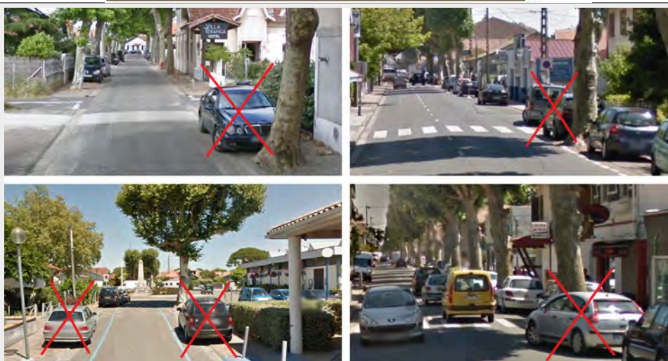
Du stationnement gênant la visibilité des usagers vulnérables dans Andernos, en amont de traversées de l'EV1 (à gauche) et en amont de passage piéton sur la RD3 (à droite). Cerema.
