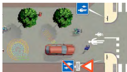
Le marquage en entrée d'aire piétonne
